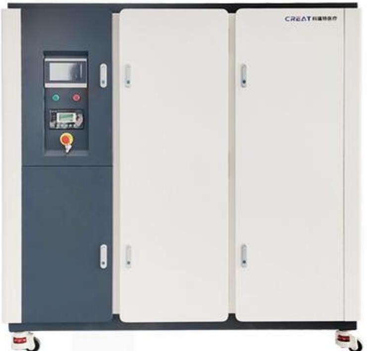
本设备为医用中心供氧系统专用制氧主机，额定产氧量为3NM<sup>3</sup>/H，氧气浓度95%，工作原理采用变压吸附（PSA）物理分离技术，以空气为原料，经压缩、净化后进入吸附塔分离氧氮，持续输出高纯度氧气。
